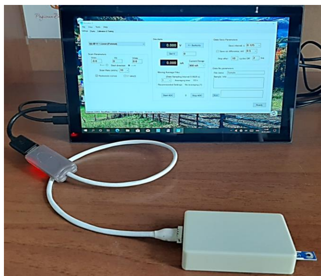
Рис. 10. Загальний вигляд портативного креатинінового аналізатора, сумісного із планшетом Microsoft Lenovo Mix 320.
